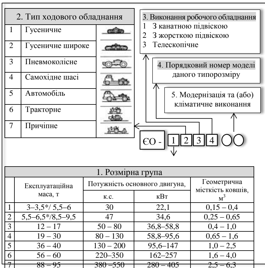
Рис. 3.1. Структура індексу одноківшевих універсальних екскаваторів
